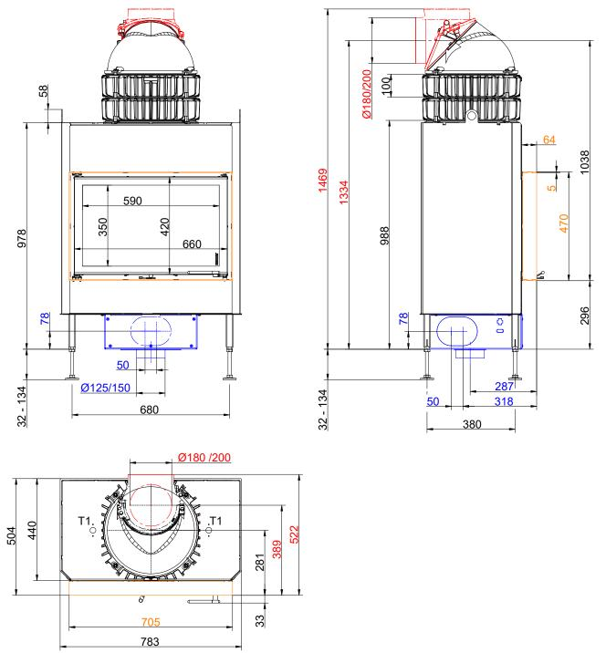
... Anbaukante und Wärmetauscherringe Guss + Gusskuppel
